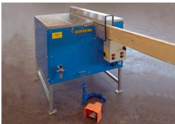
Jackningssågen är liten och kompakt och kan enkelt flyttas runt på t.ex en pall med pallyftare
