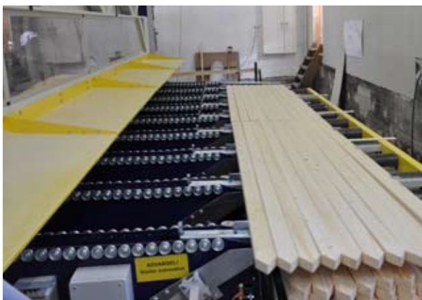
Efterhantering av virket inkluderar automatisk stapling av virket och transport av kompletta virkespaket.
