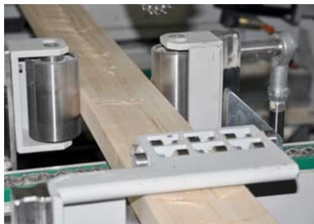
DC600 fixerar och håller virket på plats i x- y- och z-led under kapning.
