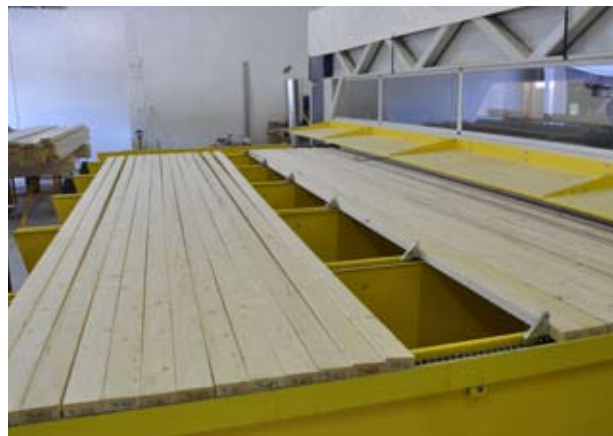
Sågen kan utrustas med manuell eller helautomatisk plockare av virke.
